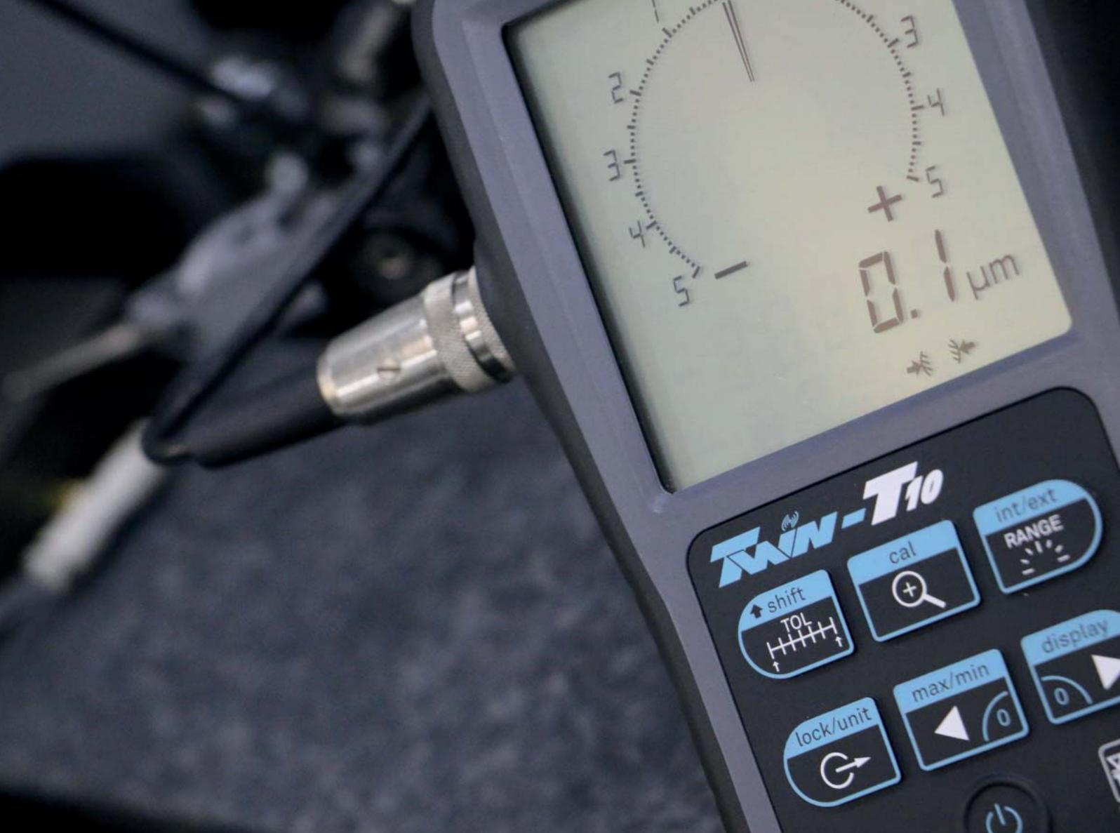
La graduation avec 200 ségments du TWIN-T10 permet une visualisation au micron lors de mesures géométriques.
