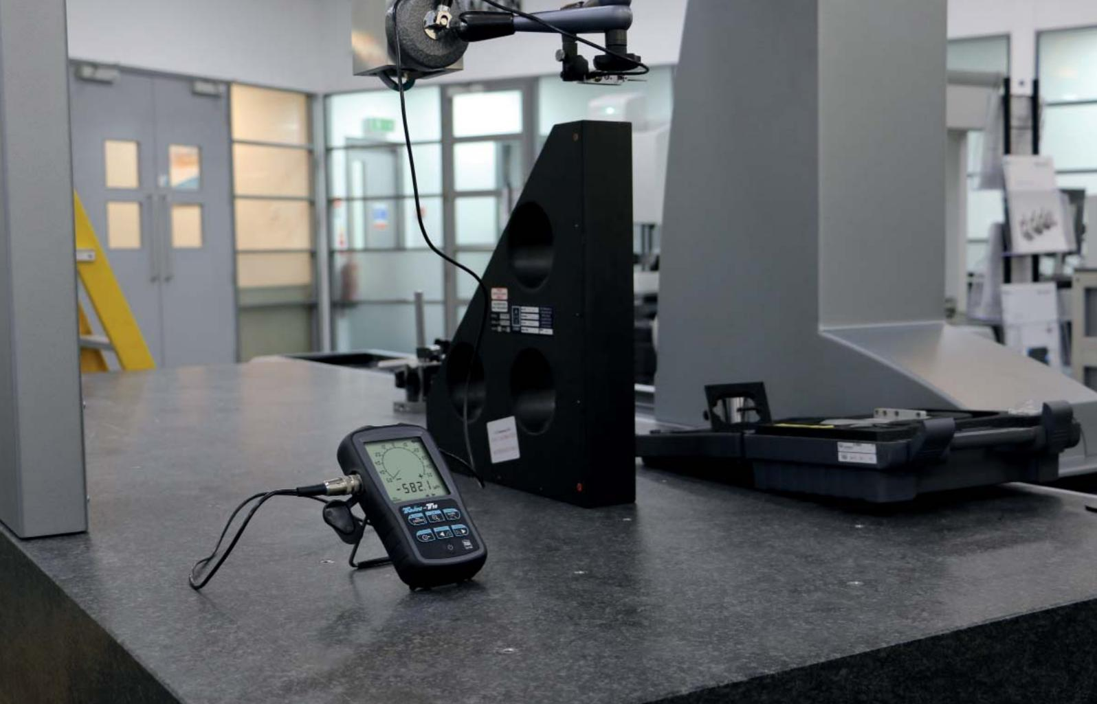
Alignement mécanique de la perpendicularité ZX d'une MMT avec le TESA TWIN-T10.
