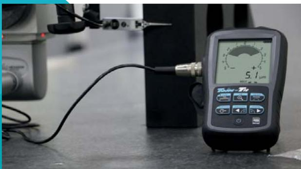
L'alignement est facilité en choisissant l'échelle analogique automatique de l'afficheur TESA TWIN-T10
