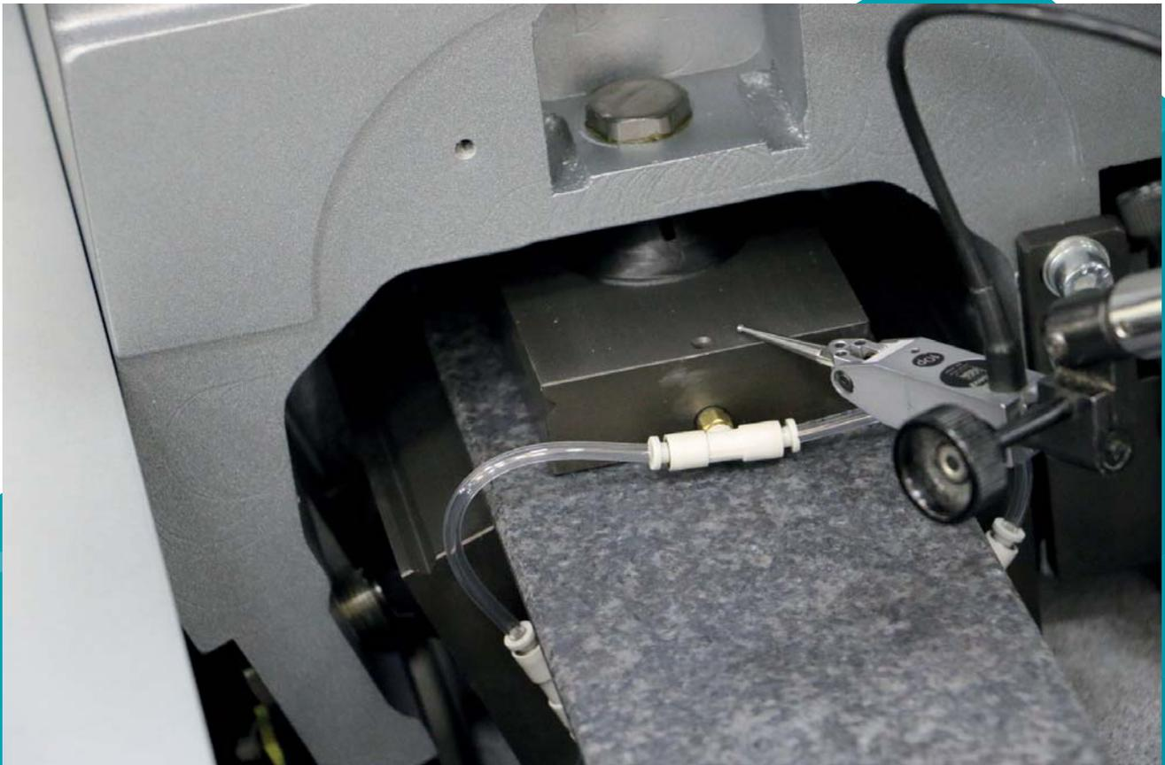
Contrôle de la course des coussins d'air sur une MMT à une tolérance de 10.0 microns +2/ -0.
