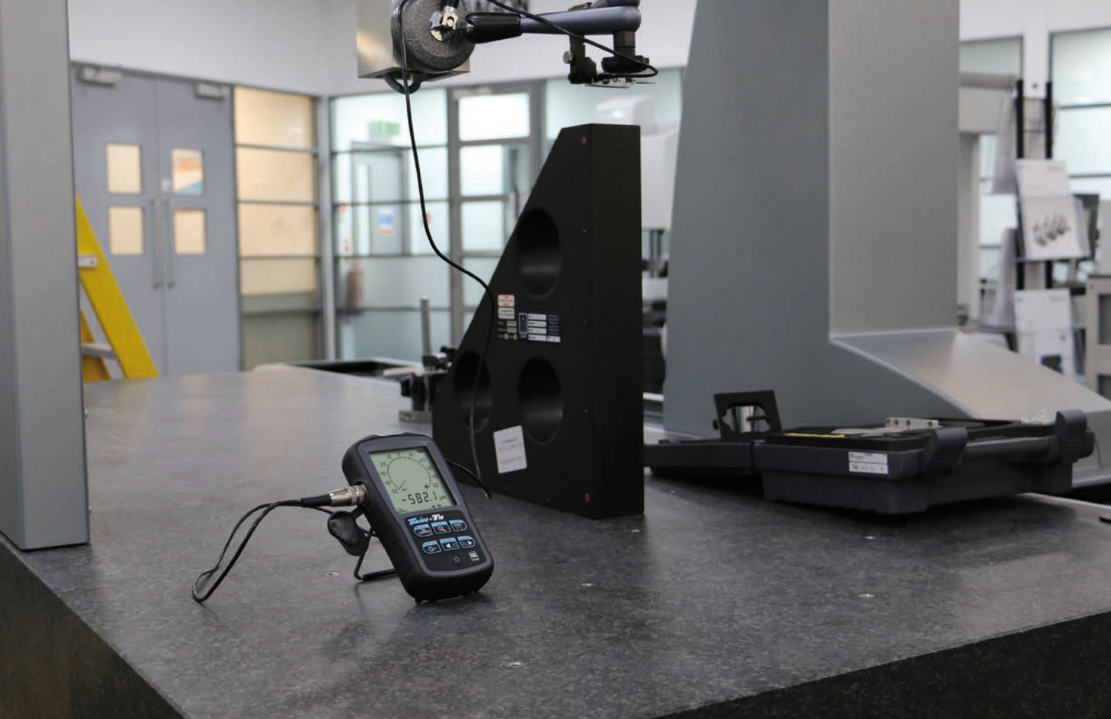
Mechanische Ausrichtung der ZX-Rechtwinkligkeit eines GLOBAL CMM mit dem TESA TWIN-T10.
