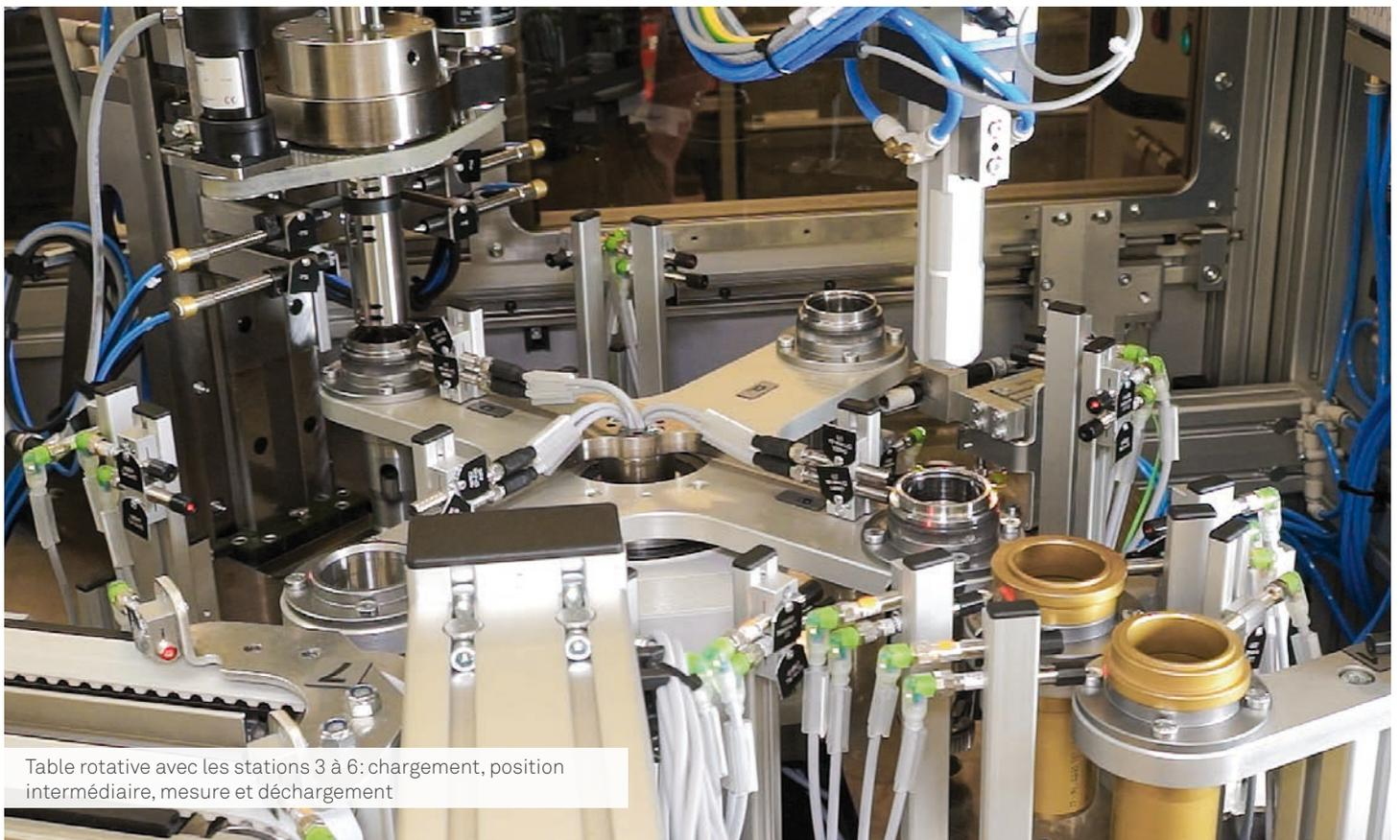
Table rotative avec les stations 3 à 6: chargement, position intermédiaire, mesure et déchargement
