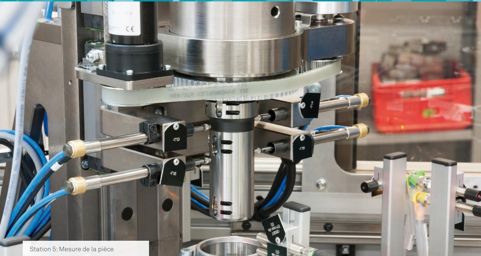
Grâce à la multiplication des stations de la table rotative, plusieurs opérations sont effectuées simultanément: une pièce est chargée, pendant qu'une autre se trouve à la position intermédiaire, tandis qu'une troisième est mesurée et une quatrième est déchargée. Lors de telles applications en milieu industriel, un contrôle de qualité efficace, fiable et surtout rapide est essentiel.
