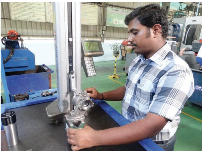
Mesure d'alésage sur un carter usiné monté sur Vé
