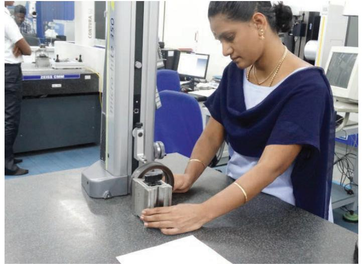
Mesure d'une bague étalon
