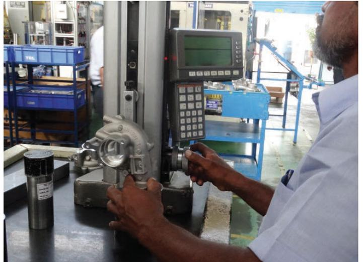
Contrôle bidimensionnel des positions d'alésages sur un carter usiné
