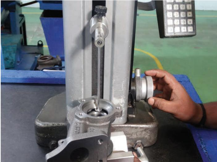
Mesure de profondeur d'un carter usiné monté sur Vé
