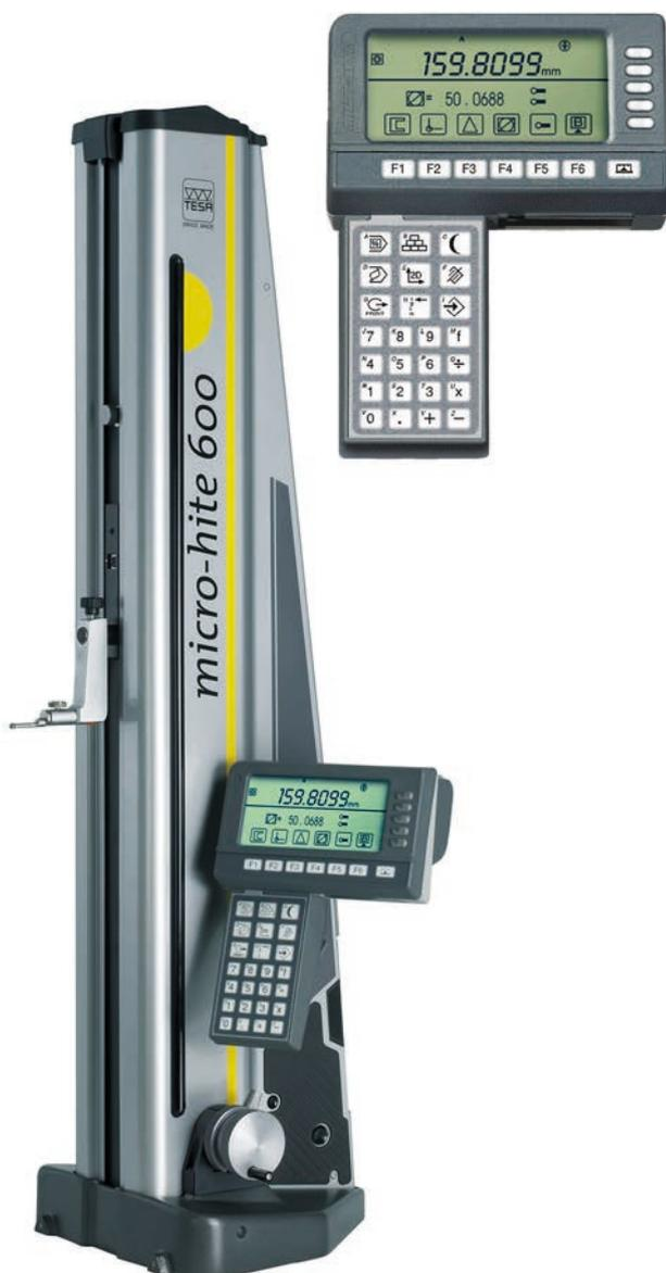
Le mesureur vertical électronique MICRO-HITE de TESA est utilisé dans un grand nombre d'ateliers ou de locaux de contrôle pour la mesure de pièces de précision. Cet instrument fonctionnant sur batterie permet de s'affranchir de tout câble et glisse sur le marbre de contrôle grâce à son coussin d'air intégré. Il permet de mesurer des dimensions intérieures, extérieures, de hauteur, de profondeur et de distance sur des éléments géométriques à surfaces planes, parallèles ou cylindriques.
