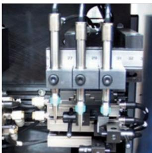
**Les palpeurs inductifs restent inégalés lors de mesures multidimensionnelles ou multicotes d'une pièce, dans un délai très court, exigeant une haute précision et répétabilité. La mesure comparative détermine la déviation de la pièce par rapport à une pièce étalon.**
