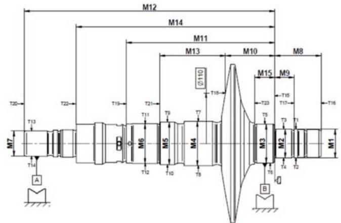
Schéma de mesure des différentes caractéristiques
