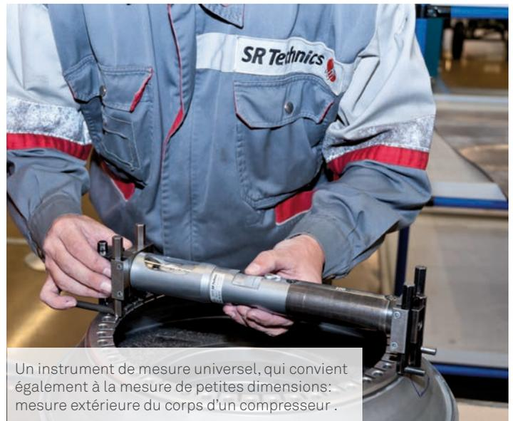
Un instrument de mesure universel, qui convient également à la mesure de petites dimensions: mesure extérieure du corps d'un compresseur .
