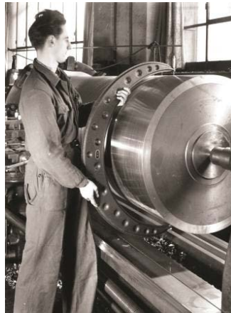
Micromètre TESA pour la mesure d'un grand diamètre
