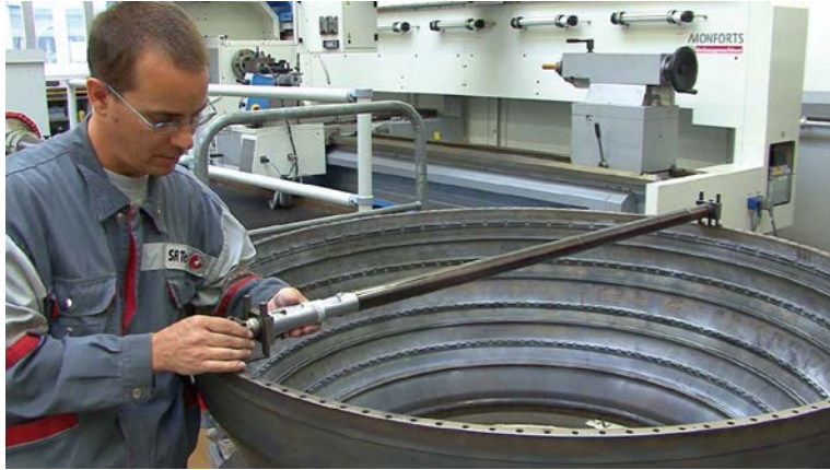
Application d'un UNIMASTER pour la mesure d'un grand diamètre
