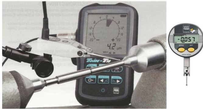
Palpeur à levier GT 31 et comparateur électronique
