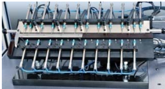
Dispositif de mesure multi-cote doté de palpeurs de type GT
