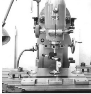
Application TESATAST pour la mesure du battement
