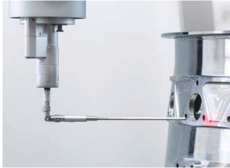
Palpeur tactile muni d'un stylet pour MMT
