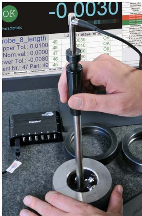
Mesure comparative intérieure avec un palpeur USB, un VERIBOR et une bague étalon
