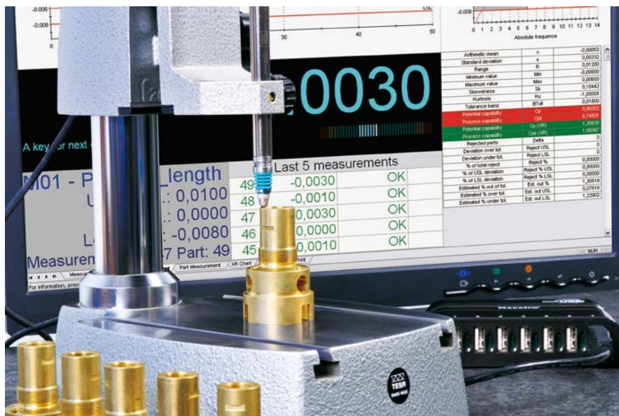
Mesure d'un lot de pièces avec affichage des mesures sur le logiciel STAT-EXPRESS
