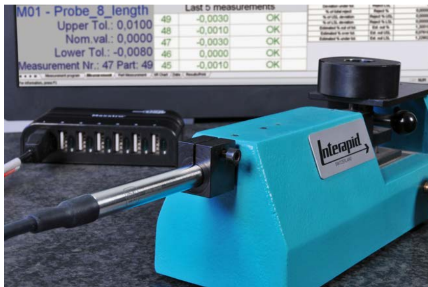
Utilisation d'un palpeur USB avec un banc de mesure INTERAPID SHE
