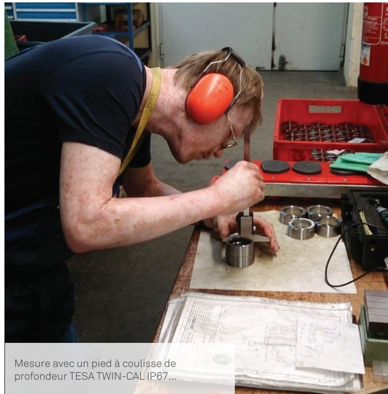
Mesure avec un pied à coulisse de profondeur TESA TWIN-CAL IP67...
