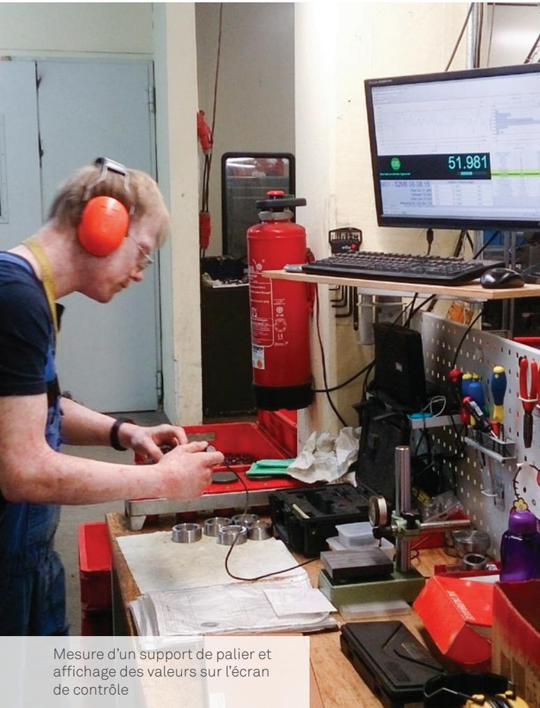
Mesure d'un support de palier et affichage des valeurs sur l'écran de contrôle
