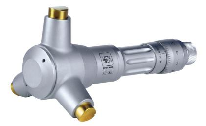
Les micromètres d'intérieur de la gamme TESA IMICRO offrent un avantage certain sur le marché. Leur technologie est unique car elle offre une mesure précise et rapide d'alésages cylindriques. En effet, l'entraînement des touches par le cône en colimaçon rectifié permet un contrôle linéaire du déplacement de l'instrument. De plus, le rochet permet une force de mesure constante.
