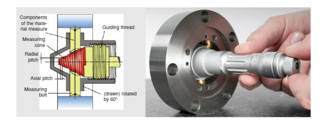
Les 3 touches, disposées à 120°, garantissent un auto-alignement et auto-centrage parfaits de l'instrument qui est perpendiculaire à la surface de l'enveloppe.
