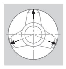
Par ailleurs, l'IMICRO est pratiquement insensible à la dilatation thermique, y compris pour des mesures de grandes profondeurs. Ceci grâce à la concentration dans la tête de mesure des parties déterminantes pour la mesure.
