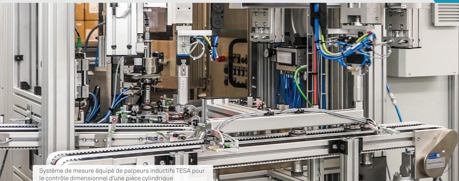
Système de mesure équipé de palpeurs inductifs TESA pour le contrôle dimensionnel d'une pièce cylindrique
