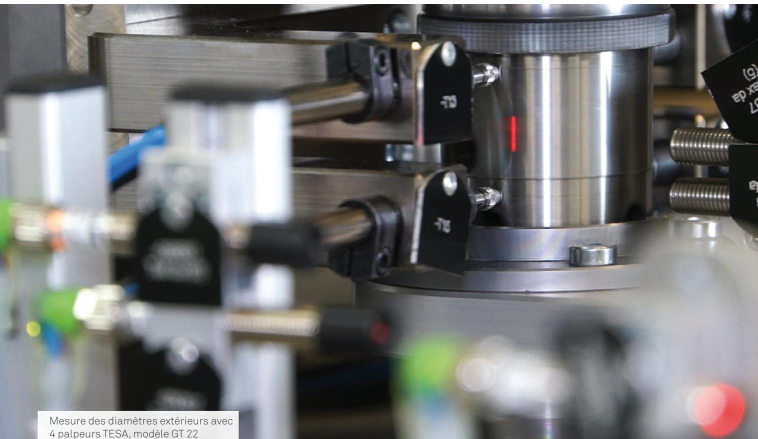
Mesure des diamètres extérieurs avec 4 palpeurs TESA, modèle GT 22
