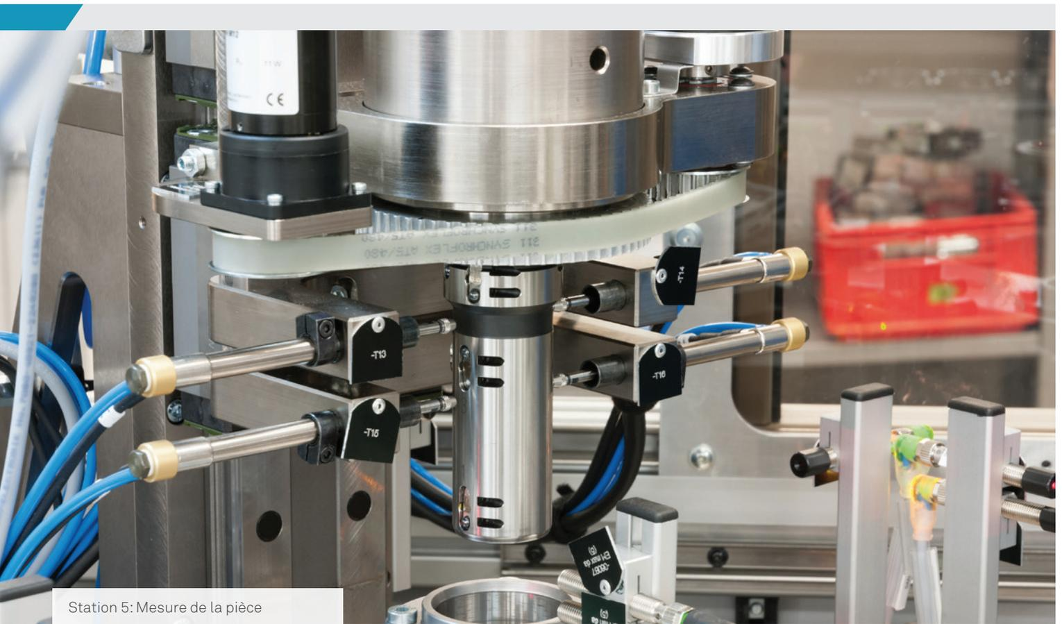
Grâce à la multiplication des stations de la table rotative, plusieurs opérations sont effectuées simultanément: une pièce est chargée, pendant qu'une autre se trouve à la position intermédiaire, tandis qu'une troisième est mesurée et une quatrième est déchargée. Lors de telles applications en milieu industriel, un contrôle de qualité efficace, fiable et surtout rapide est essentiel.
