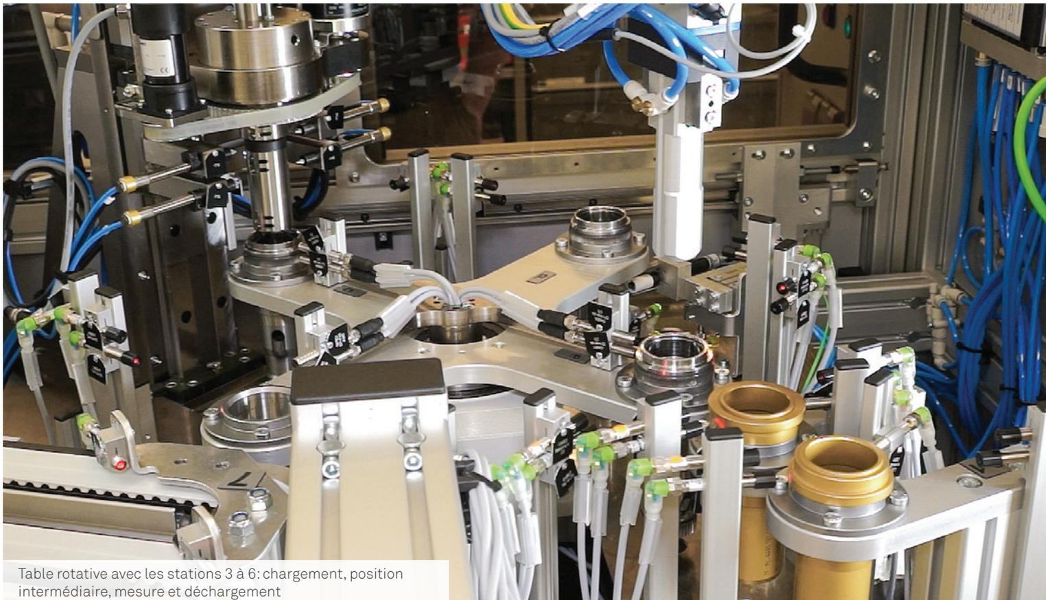
Table rotative avec les stations 3 à 6: chargement, position intermédiaire, mesure et déchargement
