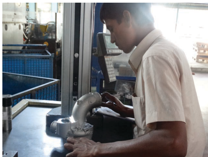
Mesure de l'alésage d'un carter usiné
