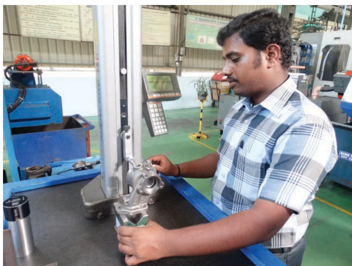
Mesure d'alésage sur un carter usiné monté sur Vê
