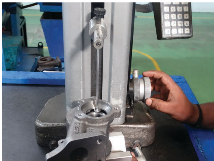
Mesure de profondeur d'un carter usiné monté sur Vê
