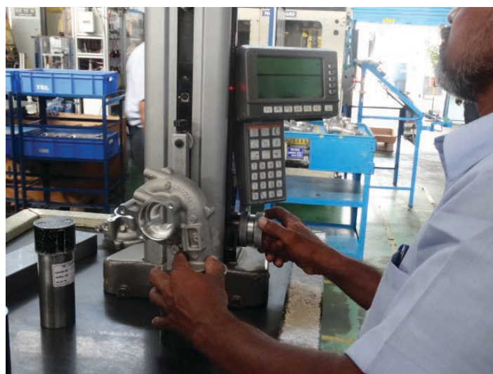
Contrôle bidimensionnel des positions d'alésages sur un carter usiné
