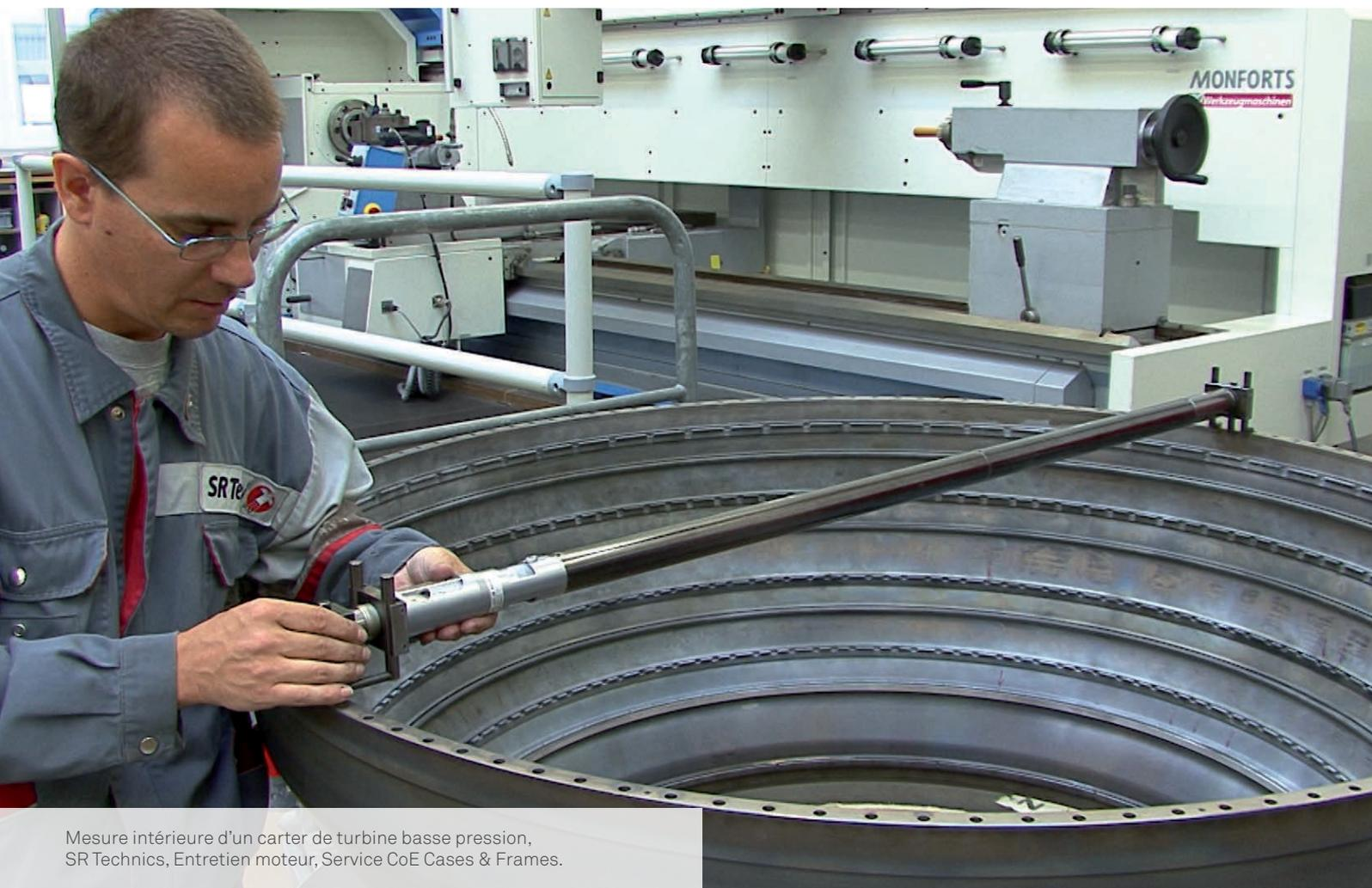
Mesure intérieure d'un carter de turbine basse pression, SR Technics, Entretien moteur, Service CoE Cases & Frames.
