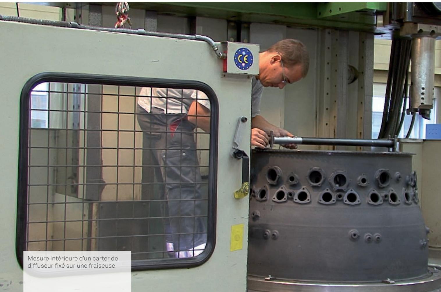
Mesure intérieure d'un carter de diffuseur fixé sur une fraiseuse
