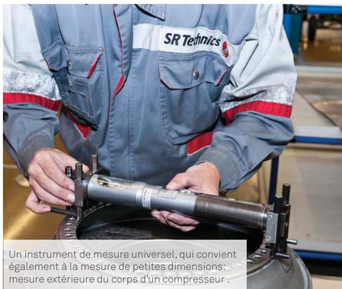
Un instrument de mesure universel, qui convient également à la mesure de petites dimensions: mesure extérieure du corps d'un compresseur .
