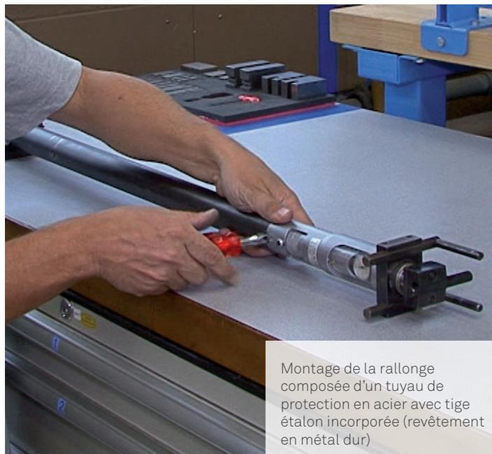
Montage de la rallonge composée d'un tuyau de protection en acier avec tige étalon incorporée (revêtement en métal dur)
